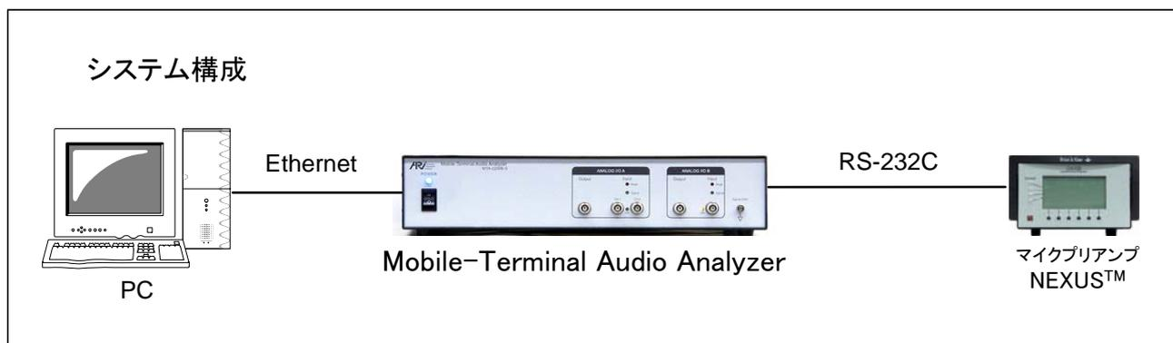
本装置を使用した測定システムは、アプリケーションソフトウェアがインストールされたパソコン、本測定器、NEXUS™ シリーズマイクロホンアンプで構成されています。
